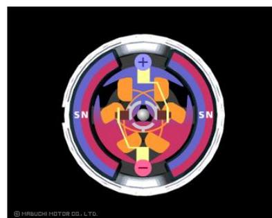
コイルは電流の向きによって極性が変わるので回転方向を変えることができます。
