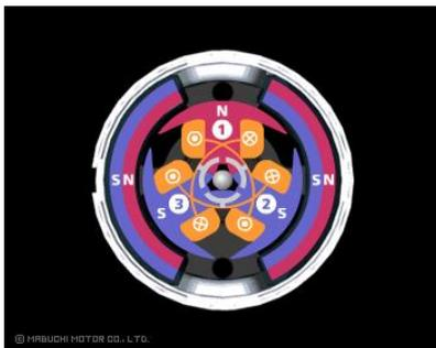
コイルとは銅線を巻いたものです。コイルには電流を流すと磁界を発生させるという特徴があります。それによりロータの回転に伴って極性を変更することができます。
