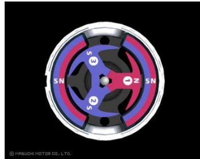
この時磁石が右図の様に①がN極、②③がS極になっていれば、違う極同士は引き寄せ合い、違う極同士は反発しあうので図2から図3のようにロータが右向きに移動します。これをずっと繰り返して回転させるにはロータの上半分をN極、下半分をS極にし続けなければいけません。
